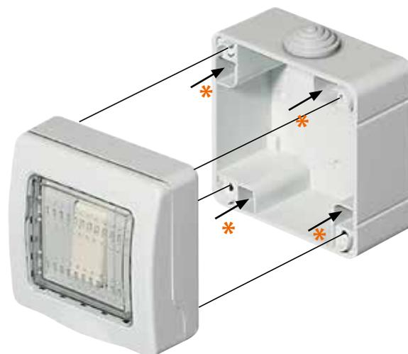
\* Para garantizar el grado de protección IP55, es necesario fijar la caja a la pared insertando los tornillos en los espacios indicados por las flechas.
