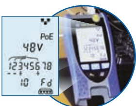
Detección de servicios
