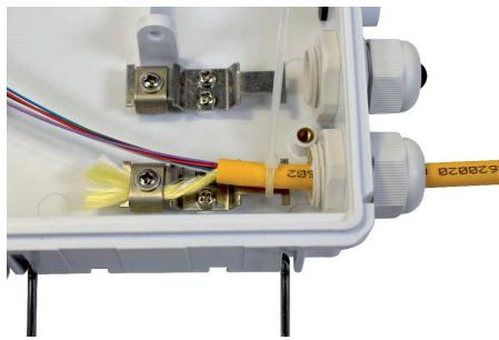
**Introduzca el cable y fije accesorio de paso / Insert the cable and fasten the pass-through accessory.**
