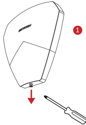
1 用工具拧下底部螺丝，打开前后壳。
